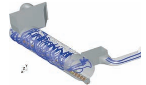
Sandfang einer kommunalen Abwasserreinigungsanlage
