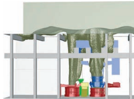
Sekundärentstaubung zur Reduktion von diffusen Schadstoffemissionen in einem Stahlwerk
